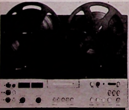
Afb. 9. TG 1000 magnefoon van BRAUN heeft drie motoren waarvan de toonmotor elektronisch wordt geregeld.
